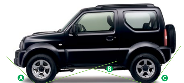
A Lähestymiskulma 37° B Ylityskulma 31° C Jättökulma 46°
